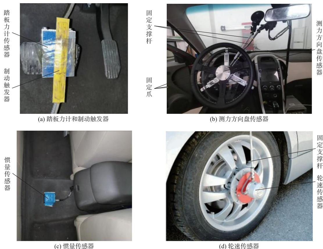
图 4 主要传感器的安装细节图
