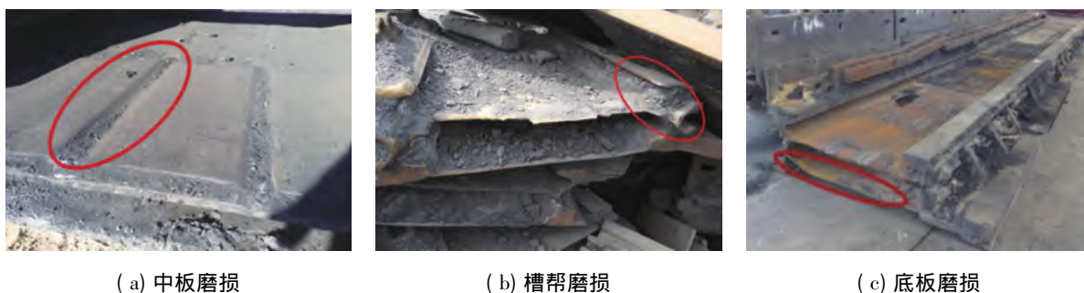
图1 刮板输送机中部槽磨损
