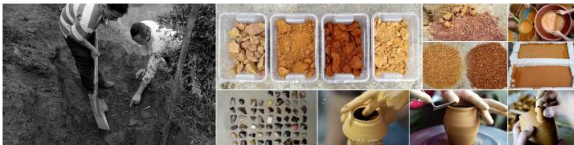
图10 茶土制器过程(取土/分类/捣碎/打浆/滤水/试验/制作)
