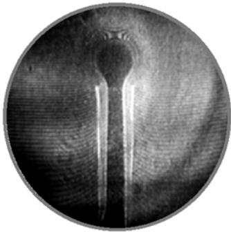
图7 空间微重力环境下液滴尾迹的热毛细迁移激光干涉图
