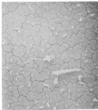
图 4 热处理后光纤内壁  $\text{GeO}_2$  状态电子显微镜照片
