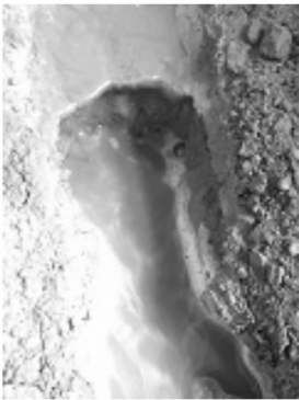
图 4 跌坑成熟阶段 Fig. 4 Drop pit mature stage
