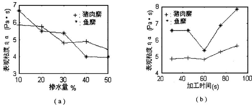
图3 表观粘度和掺水量、加工时间的关系
