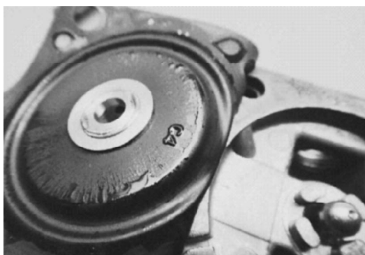
图2 有异响的精密调压阀解体图
