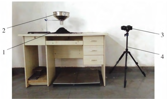
1—耐磨钢板; 2—漏斗; 3—相机; 4—三脚架。
