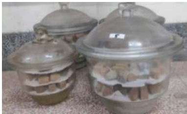
图 2 蒸汽平衡法的密闭容器 Fig. 2 Sealed container for the vapor equilibrium technique
