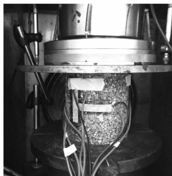
图 2 MTS-810 抗压回弹模量试验
