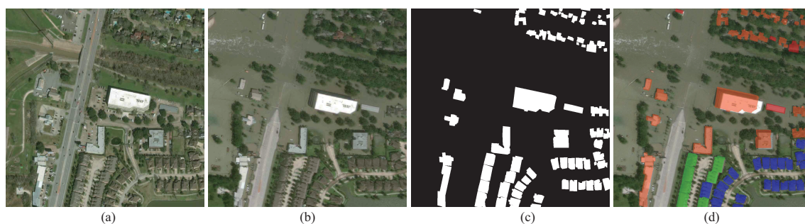
图 1 (网络版彩图) 自然灾害后的多级别变化示意图. (a) 灾害前图像; (b) 灾害后图像; (c) 建筑真值; (d) 多级别变化真值. 其中的 4 种颜色代表 4 种损毁等级: 绿色、蓝色、橙红色和红色分别表示无损毁、轻微损毁、严重损毁和完全损毁
