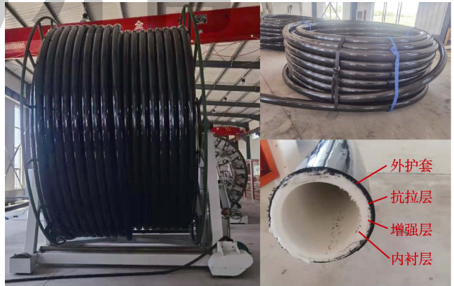
图 7 非金属复合连续管实物图
