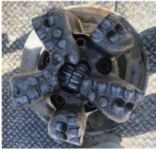
图2 Crush & Shear<sup>TM</sup>混合布齿钻头
