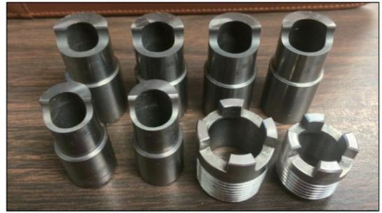
图3 内置弯曲喷嘴及钢质保护套
