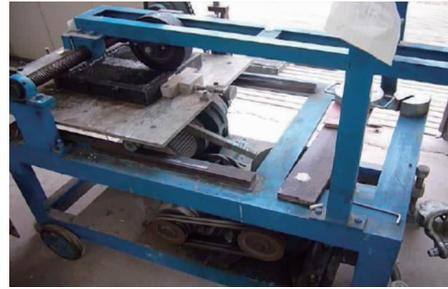
(a) 自制除冰雪试验仪
