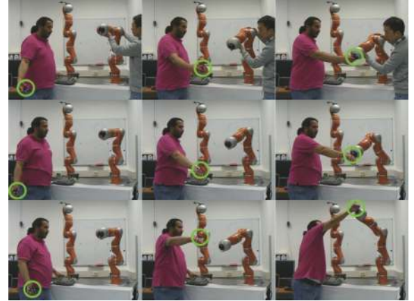
图7 KMP 在人机交互中的应用 [34] . 第一行表示技能示教, 第二行为技能复现, 第三行对应新情形下的技能泛化
