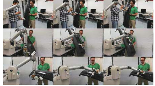
图 1 KMP 在粉刷任务中的应用 [30] . 第一行表示技能的示教, 第二行和第三行分别对应新情形下的泛化
