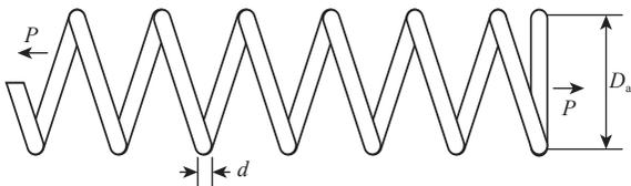
图 11 弹簧设计模型
