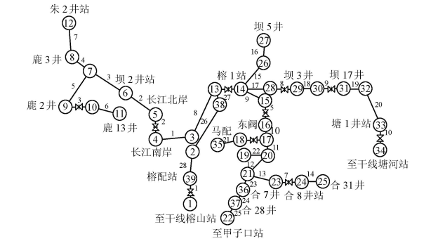
图 2 某气田现有管网仿真示意图
