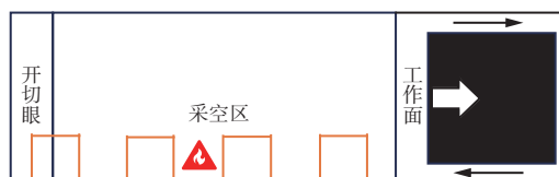
图 4 采空区分布式光纤“弓”形布设 [31]
