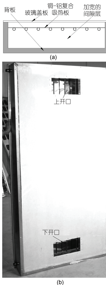
图1 与建筑一体化太阳能双效集热器模块 (a) 剖视图; (b) 背视图
