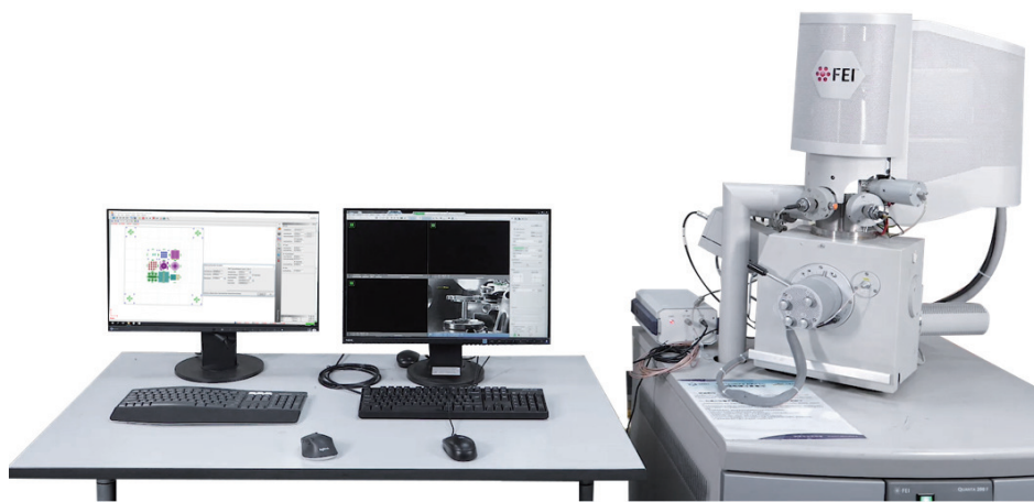
图1 改造后的 SEM-电子束光刻系统
