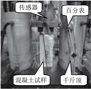
图 1 实验加载装置
