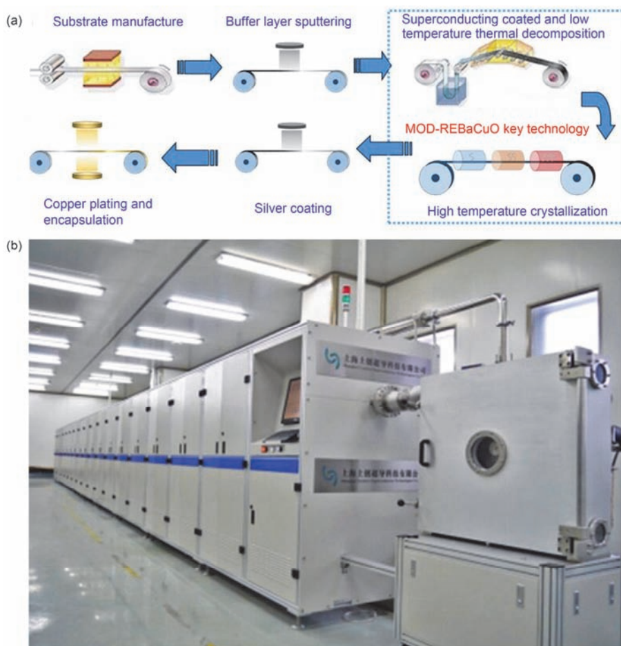
图3 (网络版彩色)化学溶液法千米级2G-HTS带材生产线。(a) 工艺流程示意图;(b) 卷对卷生产装备
