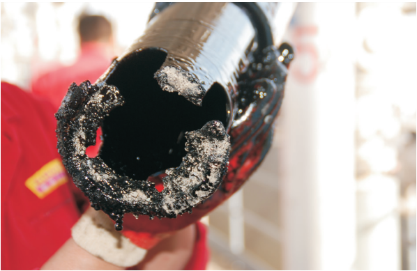
图 3 损坏的内伸缩管
