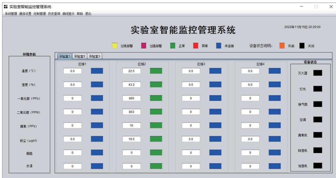
图 3 实验室智能监控系统用户界面图
