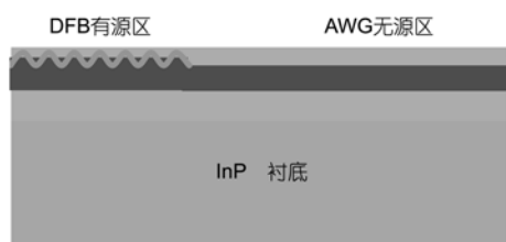
图 8 DFB LD 与无源波导 Butt-joint 耦合结构示意图
