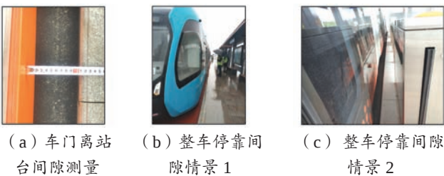
图 15 精准停站间隙测试 Fig.15 Precise docking test
