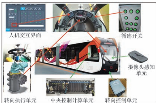
图 1 智轨电车自动循迹系统构成
