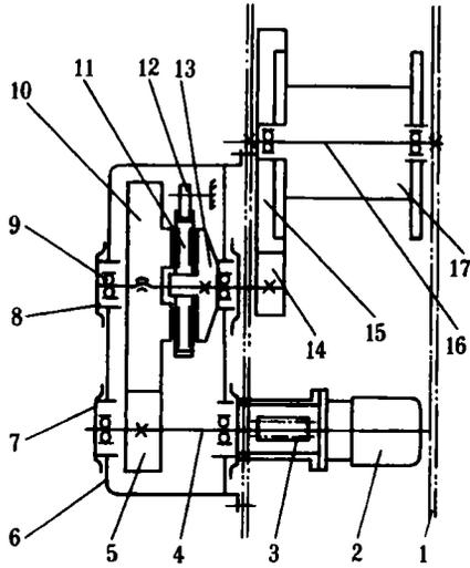
图 1 间接驱动式卷扬机构传动示意图
