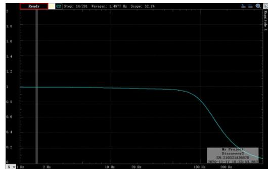
图 9 1.94 阶低通滤波器幅频响应曲线
