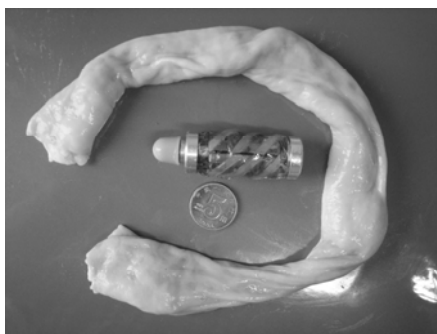
图 17 可变直径胶囊机器人与试验用离体猪大肠
