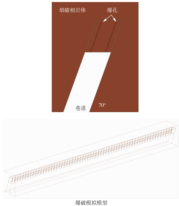
图 2 离散元模拟爆破的截面及炮孔布置方式示意图
