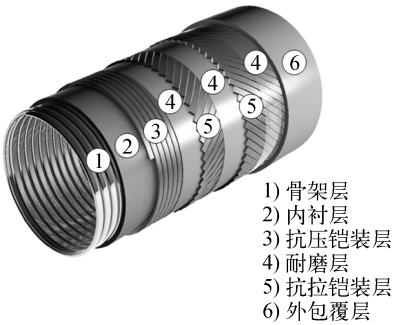
图 1 典型非黏结柔性管道结构示意图 Fig. 1 Illustration of un-bonded flexible pipe 图 2 柔性管道失效事件总结 Fig. 2 Summary of flexible pipes failure events
