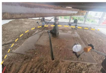
图 19 矩形荷载下挡墙顶部裂缝
