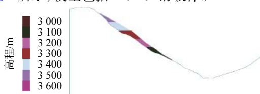
图 12 白格“10·10”滑坡2维颗粒流数值模型
