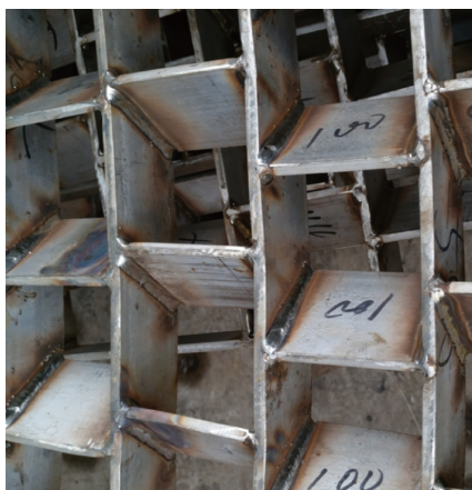
图2 中国石油大学(北京)开发的 Crosser 格栅 Fig. 2 Crosser baffle developed by China University of Petroleum (Beijing)
