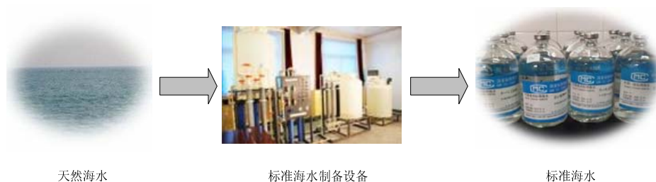
图 5 标准海水制备示意图
