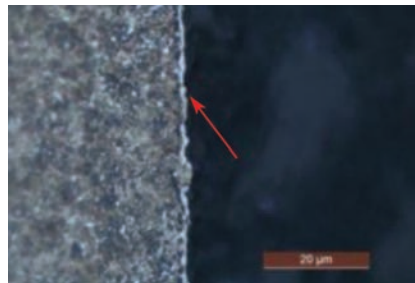
图2 故障轴承(箭头所指为电流流过痕迹)
