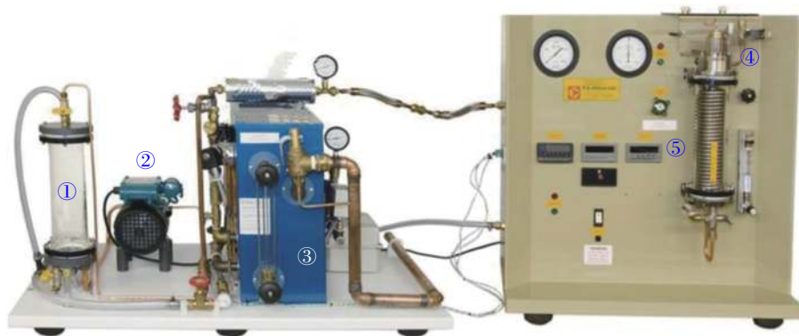
①储水器; ②给水泵; ③电加热锅炉; ④涡轮(汽轮机); ⑤凝汽器。
