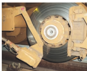
图 1 正线发生 OPG 底座断裂
