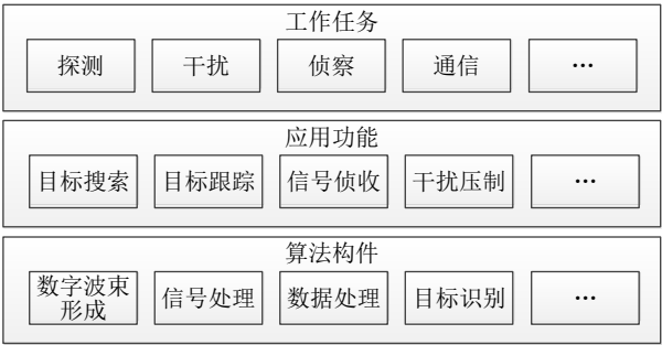
图 3 开放式相控阵系统应用层架构示意
