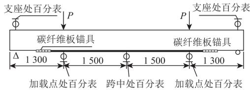
图4 沿梁长度方向百分表布置 (单位: mm)
