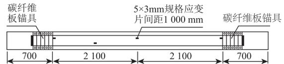
图 3 试验梁 UBPS 碳纤维板应变片布置 (单位: mm)
