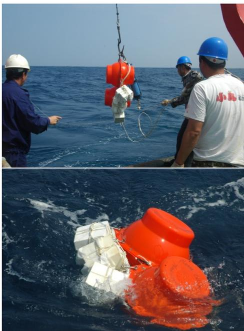
图6 固体浮力材料海试试验
