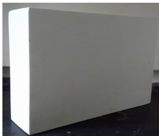
图4 理化所研制的 $300\times 400\times 100\text{mm}$ 标准浮力块
