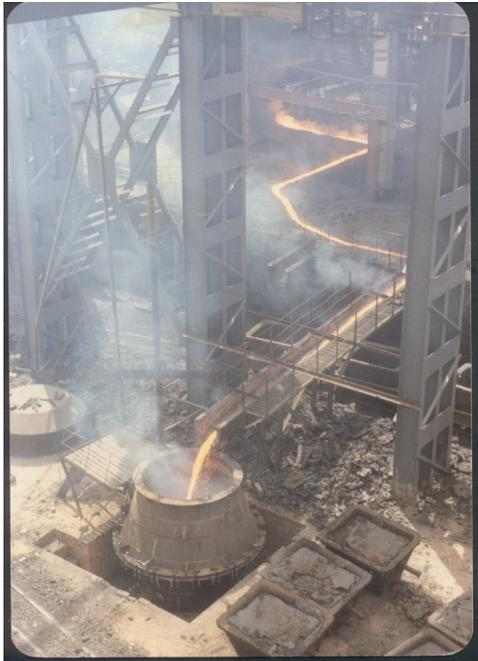
图2 高温液态高炉富稀土渣注入结晶器
