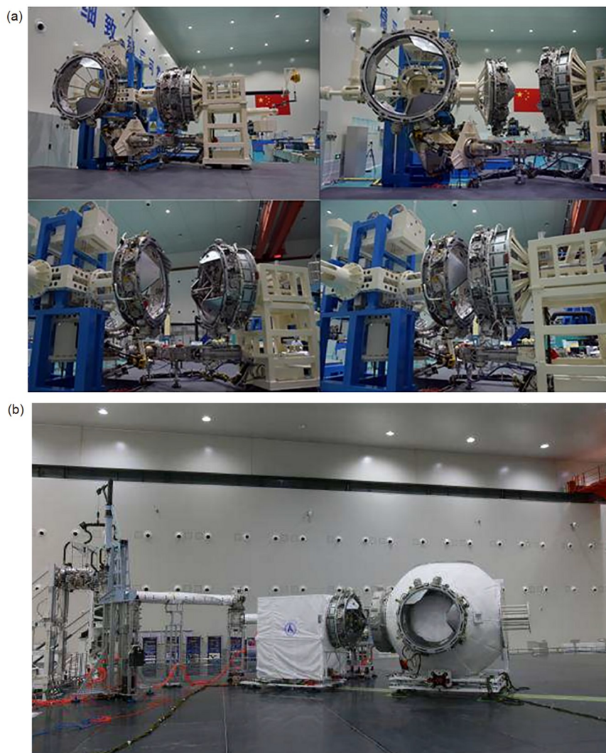
图 6 (网络版彩色)天宫空间站舱段转位专项试验。(a) 转位机构舱段转位专项试验; (b) 机械臂舱段转位专项试验
