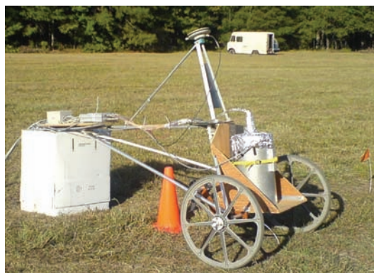
图7 美国橡树岭国家实验室研制的高温超导全张量磁梯度测量系统地面试验
