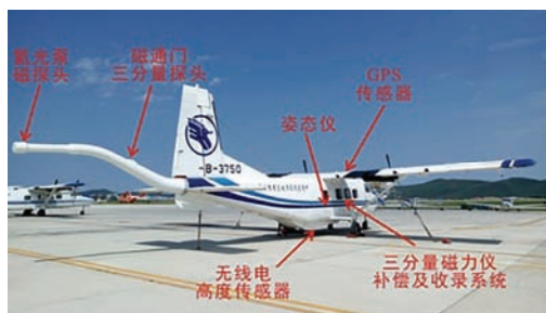
图5 国土资源航空物探遥感中心研制的航空三分量磁测系统
