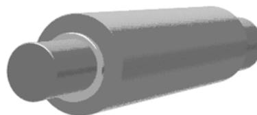
图 6 三维理想硅纳米线围栅器件
