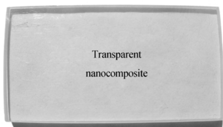
图9 高含量透明硫化锌/聚合物复合体相材料照片
