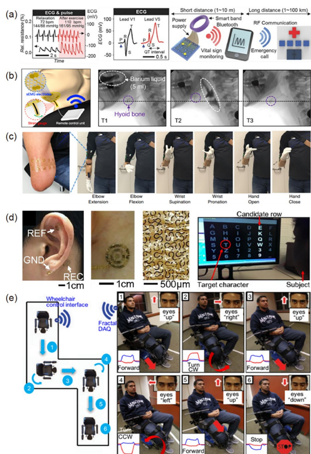
图5 (a, b) 医疗诊断和分析的应用。(a) 心脏异常问题预警 [64] , (b) 吞咽治疗 [68] ; (c~e) 人机交互的应用。(c) 控制假肢 [70] ; (d) 文本拼写 [71] ; (e) 控制轮椅 [72] (网络版彩图)
