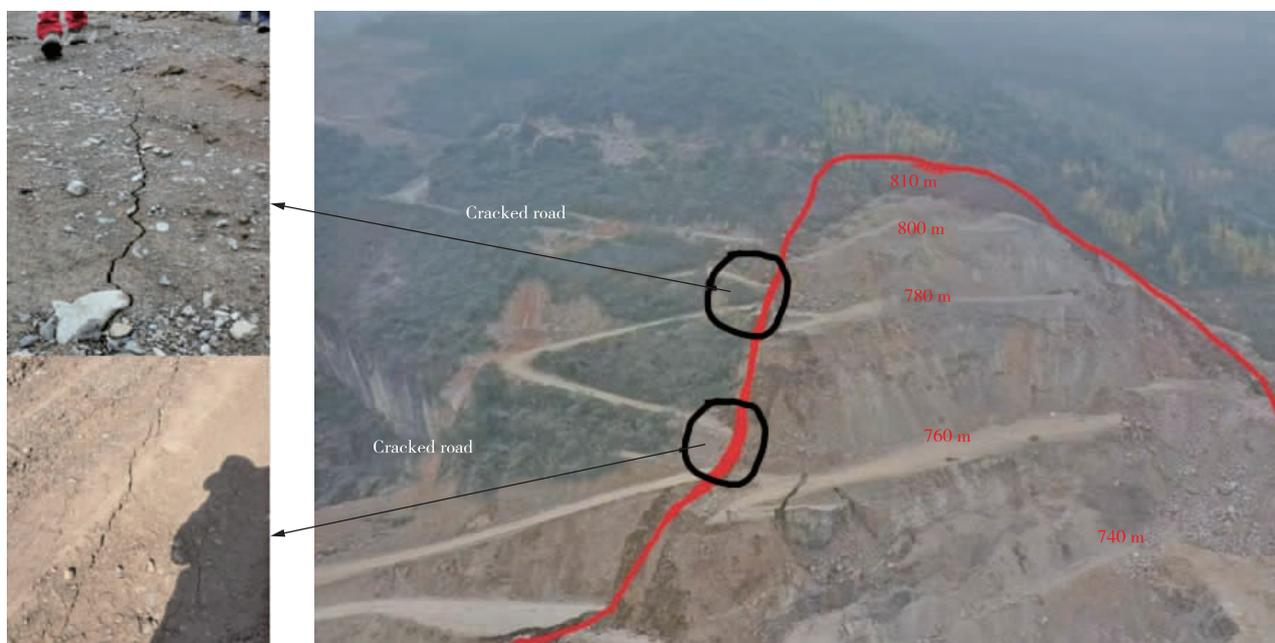
图 1 磨环凶新滑坡路面开裂及坍塌情况
