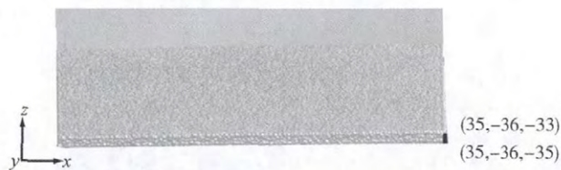
图 10 压制速度为 0.20 m/s 时的坯体高度
